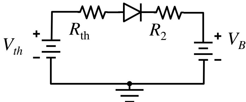
$$i_D = \frac{V_{th} - 0.7 - V_B}{R_{th} + R_3}$$
